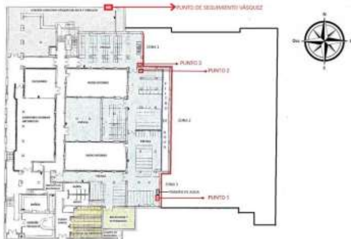
Plano 4: Puntos de seguimiento del porcentaje de humedad (%HM) en muros del sótano.
