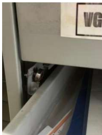
Fotografía 272: b. sistema de rodamientos deteriorado por peso. Desprendimiento de las bandejas de la planotecas (toma por Santiago González).
