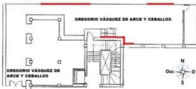
Plano 1: zonas con indicadores de humedad (línea roja) en la Reserva Vásquez durante el 2024 y que en enero de 2025 fueron reparados.
