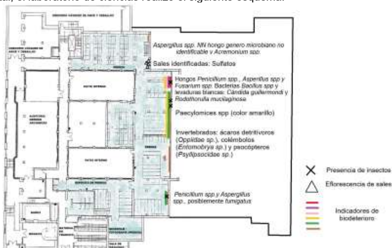
Plano 7: ubicación de los indicadores de biodeterioro y deterioro en el muro falso oriental del sótano -reserva hemerográfica- (elaboración S. Ruiz, basado en el informe de Villalba, et al., 2025)
