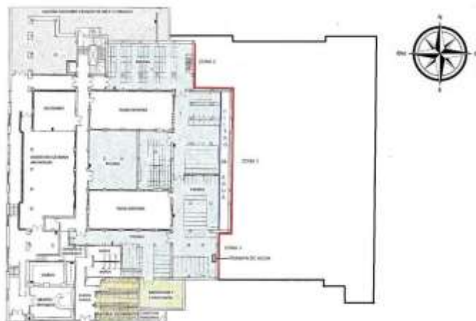
Plano 3: zonas de filtración inicial durante 2010 - 2022 y 2023. Los números de cada zona indican el orden en el que empezó a evidenciarse la inundación durante 2022 y 2023 (de norte a sur). El muro rojo coincide con todos los indicadores de humedad en prensa relacionados al filtro de agua y muro falso representado en azul.
