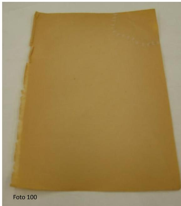
Antes y después del proceso de refuerzo de faltantes en seco en papel friable que presenta amarillamiento por oxidación.
